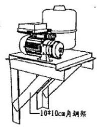
壓差式加壓馬達固定示意圖二
