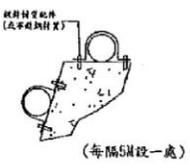
掛擋、護坡、水溝或護欄頂及側固定夾示意圖
